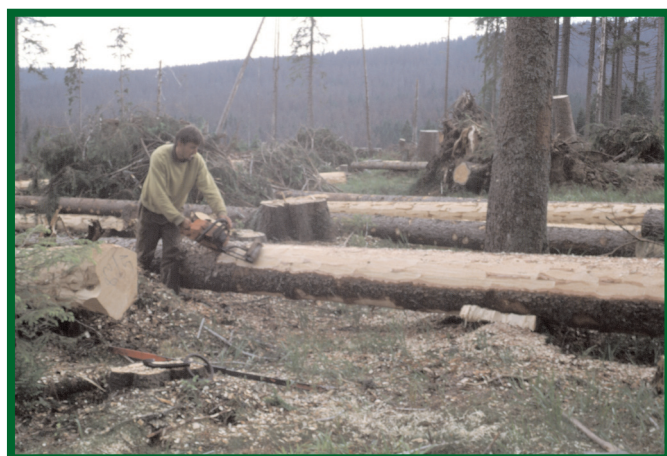
Odkorňování pomocí frézového odkorňovače neseného na motorové pile
