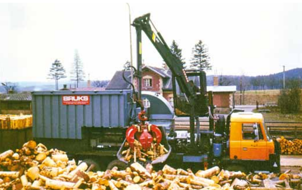
Bruks 1001 CT na Tatře se mimo jiné používal i ke štěpkování manipulačních odřezků na skladech, které byly téměř neprodejné. Proto se vydávaly buď jako deputátní palivo, nebo se štěpkovaly.
