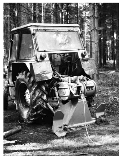
Pro vyklízování tenkého dříví k procesorům sloužil jednoduchý dvoububnový naviják kompletovaný z horské vzpěry Zetoru 50 a nakládacího navijáku TBV.
