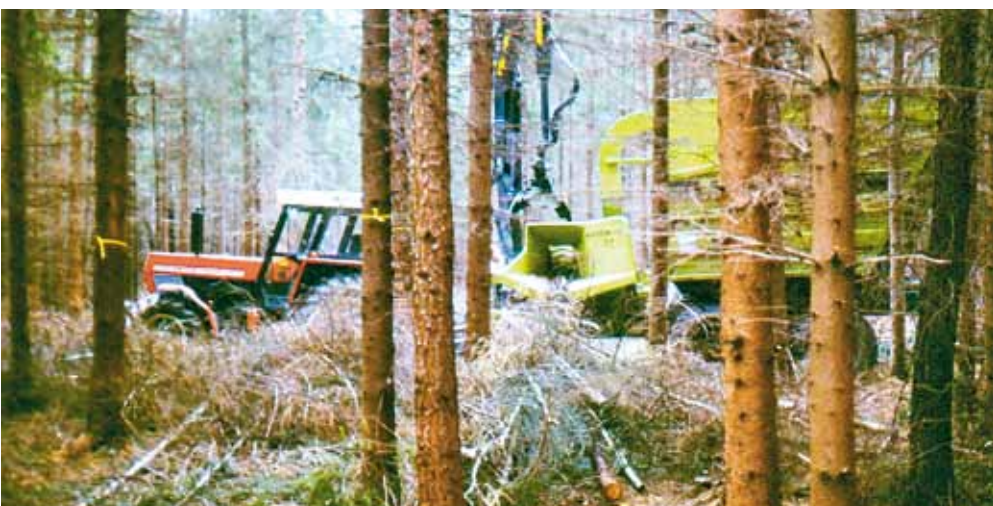
Sekačka Perusyhtymä TT 1000 TS se používala na linkách, a to zejména při štěpkování materiálu vytěženého při probírkách v podúrovni. Štěpky se foukaly do vyklápěcího zásobníku „na zádech“ sekačky, ale problémy s časovou návazností nastávaly na OM, kde téměř vždy jeden z prostředků (sekačka či odvozní prostředek) čekal na druhý.
