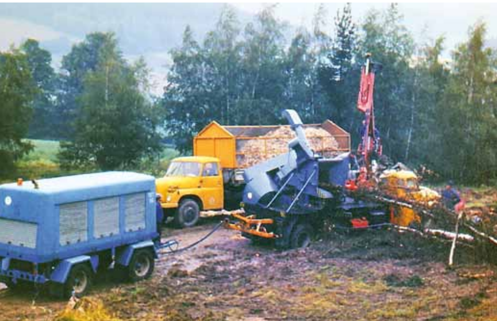
Sekačka Agroslužby Kaplice byla pokusem, jak nahradit mechanizační prostředky z dovozu. Vzhledem k tomu, že vzniklý technologický uzel zabíral spoustu místa (vlastní sekačka + dieselagregát), byla bez problémů použitelná jen při zemědělských rekultivacích, kde s prostorem nebyl problém. Pro stísněná OM by však byla použitelná omezeně.
