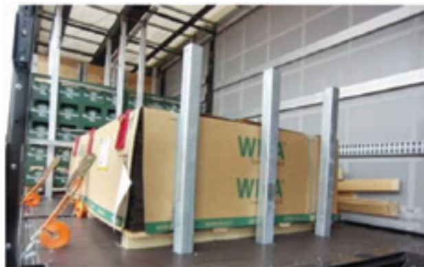
Obrázek 7: Klanice použité pro blokování nákladu ve směru dopředu
