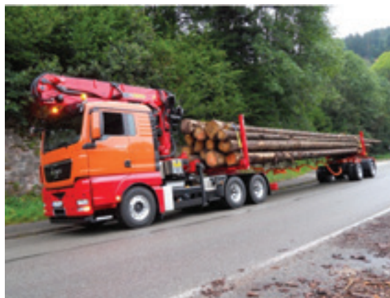
Obrázek 53: Přeprava celých stromů
