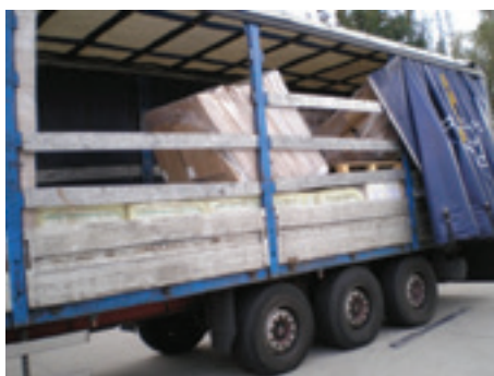
Obrázek 19: Nedostatečné zabezpečení nákladu pouze pomocí pružné obalové fólie
