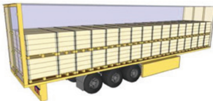
Obrázek 69: Uložení palet na vozidle s označením XL
