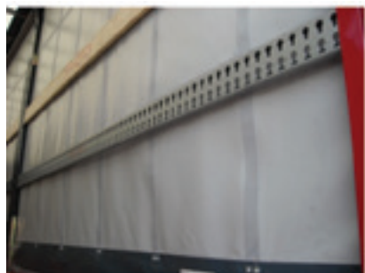
Obrázek 27: Hliníková lišta s otvory pro blokovací tyče
