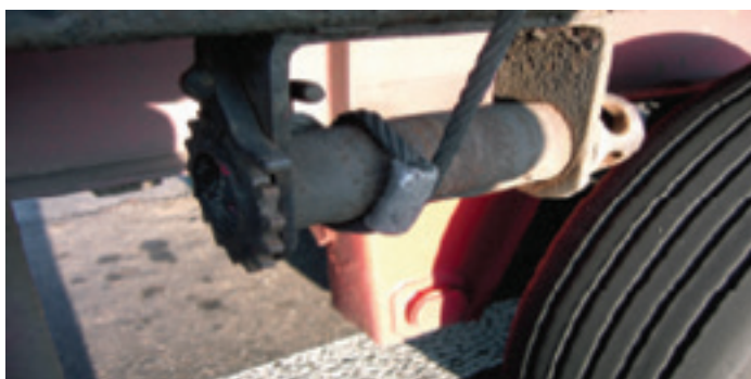
Obrázek 24: Ocelové drátěné lano napínané navijákem
