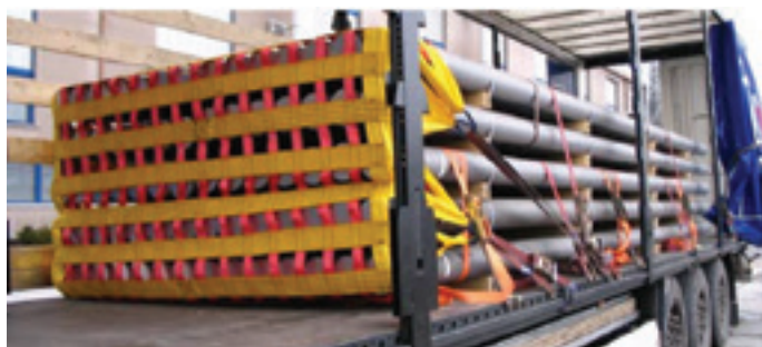
Obrázek 32: Zabezpečení sítí a přímým uvázáním ve směru dopředu
