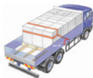
Obrázek 40: Pružné uvázání pomocí smyčky
