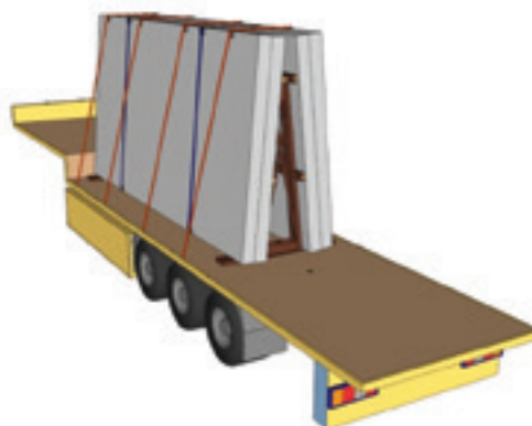
Obrázek 48: Zabezpečení kombinací blokování, rámu ve tvaru A, uvázání přes rohy a uvázání přes vrchol
