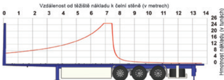
Obrázek 5: Diagram rozložení nákladu na třínápravovém návěsu
