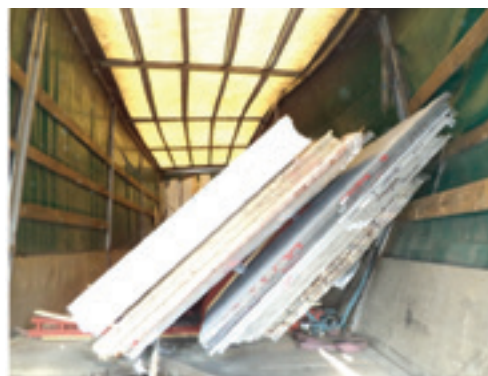
Obrázek 45: Zhroucený rám ve tvaru A
